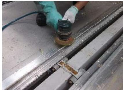
センターシートレールに破損がある場合は、ウレタンハンマー等で整形やレール交換をしてください。その際、レールにバリがあるとシートの破れの原因になりますのでバリ取りも念入りに行ってください。
