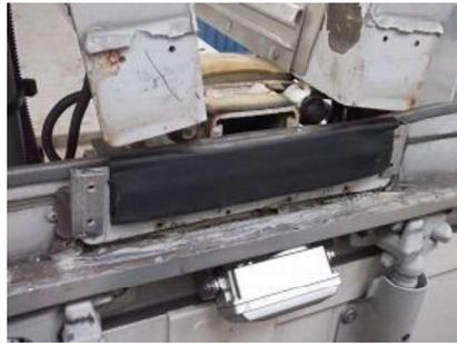
センターシート後端部を外す際、取付金具は再利用するので保管しておいてください。
