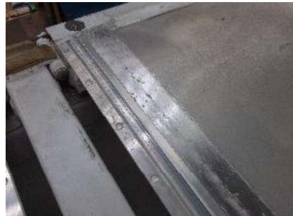
シールテープの接着剤を塗料シンナーを使用し剥がしていきます。接着剤が残っていると新しく張るシールテープの接着力に影響があるので、極力残らないよう剥がしてください。
