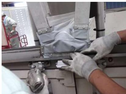
センターシートの前後端部を取り付けます。保管しておいた金具を使用してビスで固定していきます。その際、シートの折り込みに注意をしてください。
