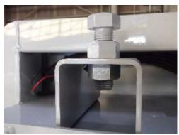
写真はリヤ側のストッパーボルトです。 調整はフロント側と同様の要領で調整してください。
