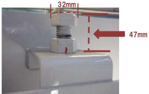
写真はフロント骨格側のストッパーボルトです。 ボルトの高さ調整は32mmのスパナ等で行ってください。 基準値は写真の部分の間隔が47mmになっていますので、極端に基準値と離れない 範囲内で調整をして下さい。
