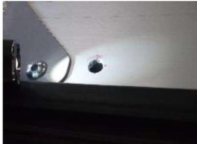
ドアに水抜き穴をあけます。位置は、ドア上部コーナーパッチ材の端部から幅方向、縦方向ともに15mmの位置にしてください。
