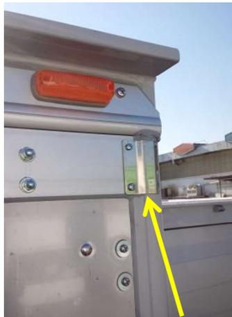
ドア表側上部のステンパッチを外します。
