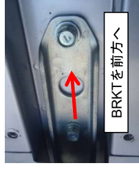
ミドルBRKT締付時はBRKTを前方へ押しながら締め付ける
