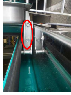
⑤ボトムレール部ガイドローラー取付、仮止め
