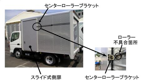
スライド式側扉のセンターローラーブラケットに組み込まれているローラーの耐久性が不足している為、当該ローラーが磨耗しシャフトが露出した状態で開閉を続けると、シャフトの磨耗及びし変形を起こし、当該扉を開けた時にセンターレールブラケットがレールから外れ、扉が脱落するおそれがある。
